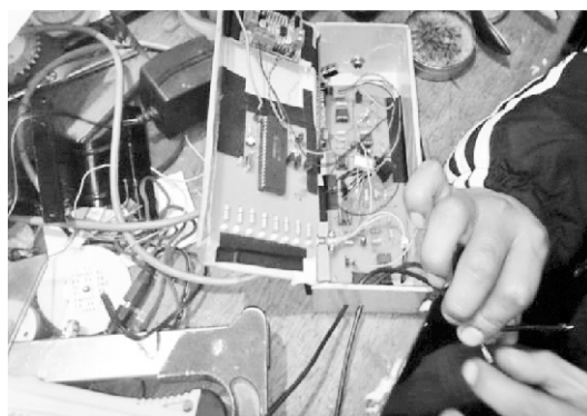
Figura N° 3. Circuito controlador de rodilla biónica
